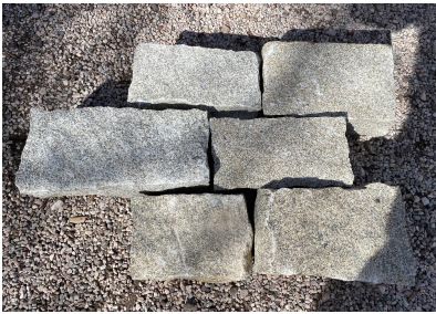
HRANOLY ŠTÍPANÉ, ŽULOVÉ, ŠÍŘKA 10 cm, VÝŠKA 10 cm, DÉLKA PROMĚNNÁ BUDE PROVEDENO NA ZÁKLADĚ VZORKU POLOŽENÉ DLAŽBY, KTERÝ ODSOUHLASÍ AD.
